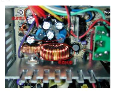
经过高频开关变压器降压后的脉动电压,同样要使用二极管和滤波电容进行整流和滤波,此外还会有 1、2 个电感线圈与滤波电容一起滤除高频交流成分。
