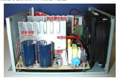
市电进入电源,首先要经过扼流圈和电容,滤除高频杂波和同相干扰信号。然后再经过电感线圈和电容,进一步滤除高频杂波。接下来再经过由 4 个二极管组成的全桥电路整流(编者注:也有半桥等其他电路),和大容量的滤波电容滤波后,电流才由高压交流电转换为高压直流电。
